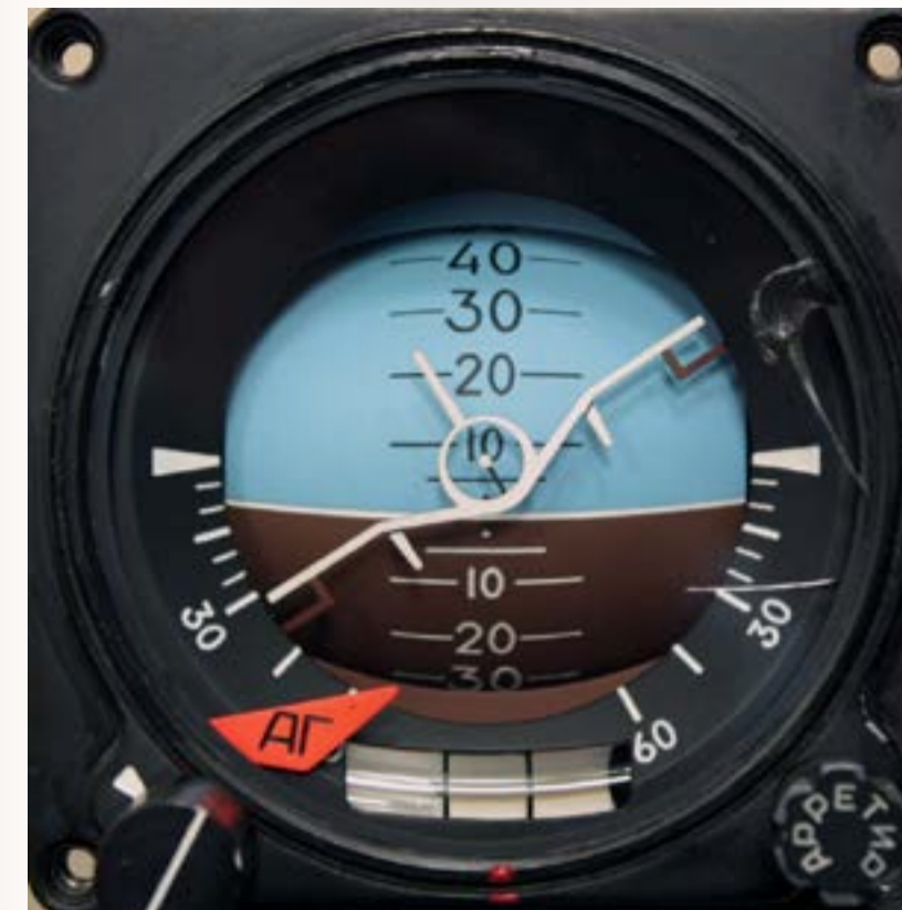
Рис. 1. Лицевая часть авиагоризонта с подвижным силуэтом самолета, «земля неподвижна по крену и подвижна по тангажу» [вид с земли на летательный аппарат]
