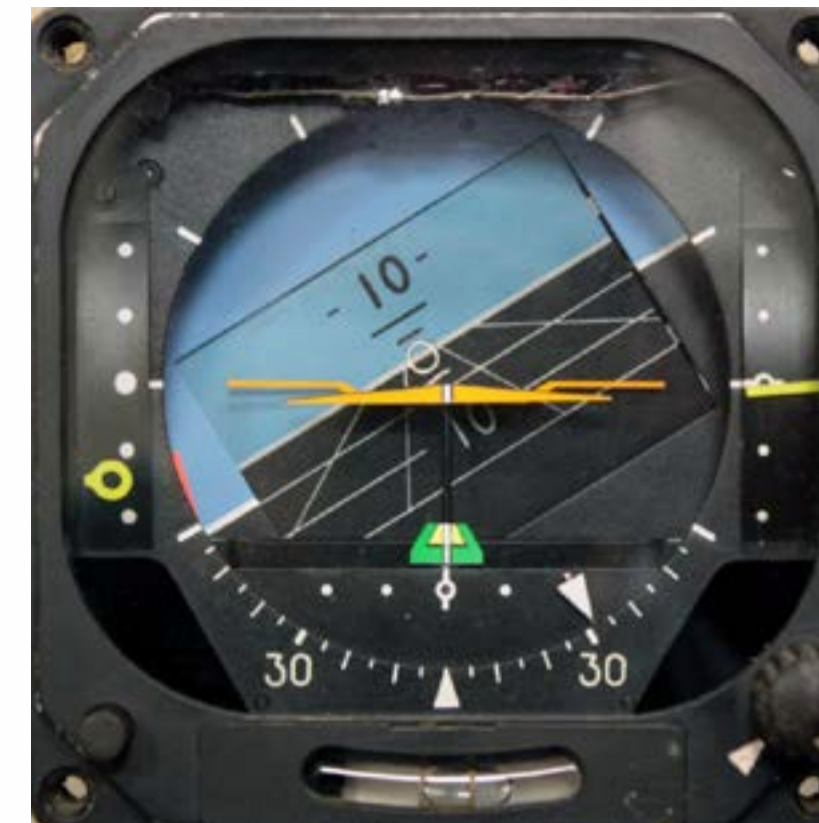
Рис. 2. Лицевая часть авиагоризонта с неподвижным силуэтом самолета, «земля подвижна по крену и тангажу» [вид с летательного аппарата на землю]
