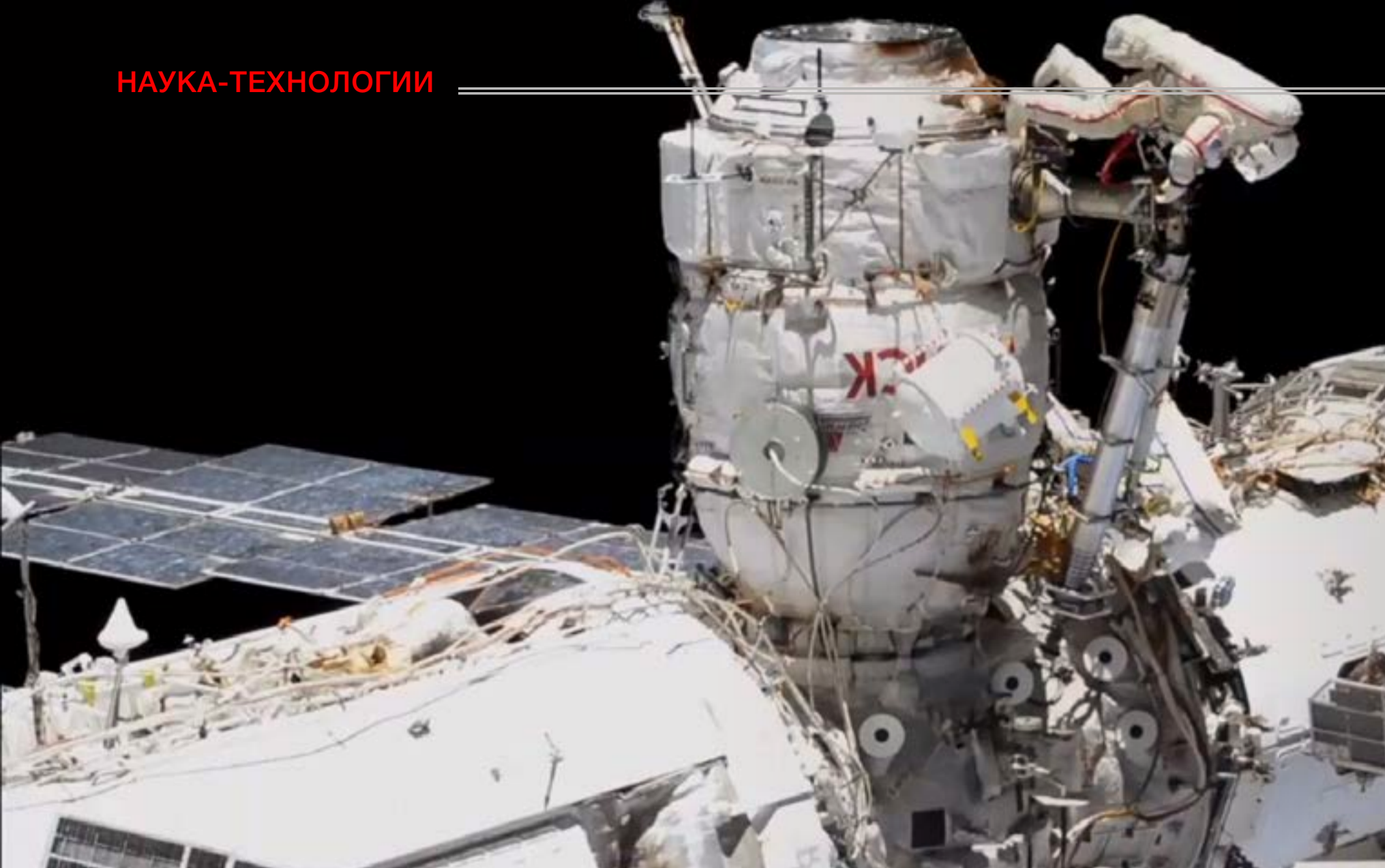
На модуле «Поиск» Олег Новицкий (вверху) работает лебёдкой, Пётр Дубров перемещается по телескопическому манипулятору «Стрела М1» (внизу, у стрелы). Фото из архива генерального директора ГК «Роскосмос»
