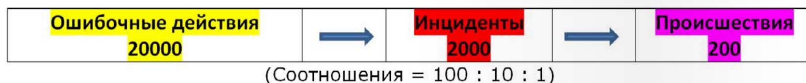
Рис.1. Вероятностные соотношения количества ошибочных действий в полетах, приводящих к авиационным инцидентам и происшествиям
