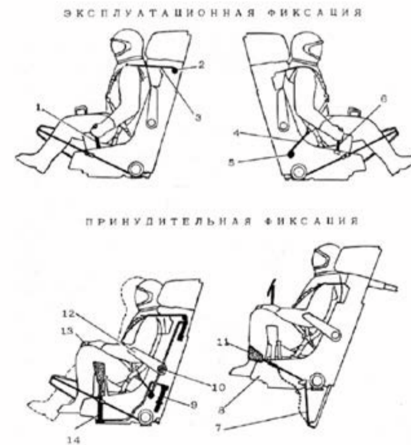
Рис. 2. Положение летчика в кабине самолета в штатном положении [эксплуатационная фиксация] и перед выходом кресла из кабины при катапультировании [принудительная фиксация] *
