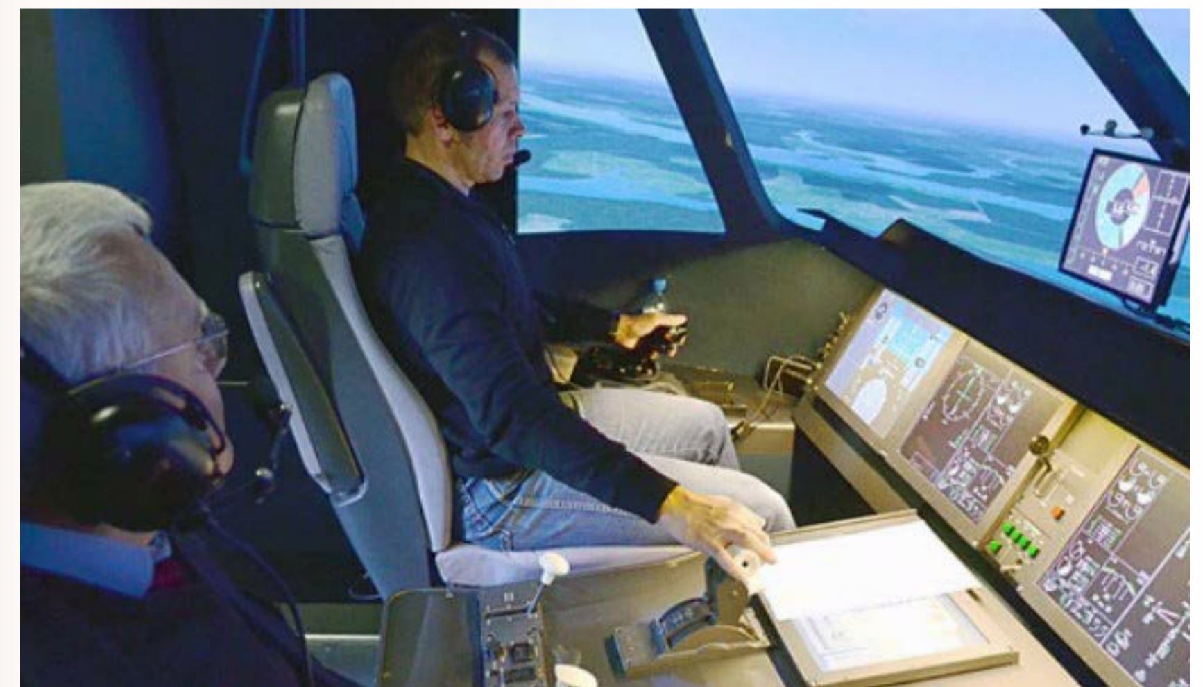
Отработка системы управления MC-21 на пилотажном стенде ПСМС ЦАГИ / Фото: tsagi.ru
