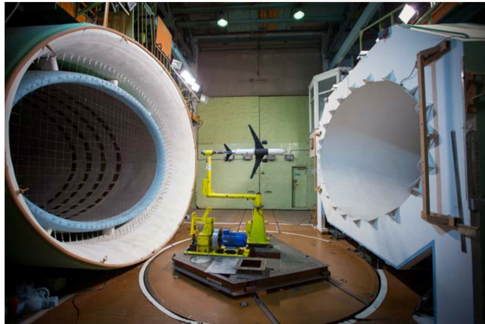
Отработка систем управления гражданского самолета в дозвуковой аэродинамической трубе ЦАГИ / Фото: tsagi.ru
