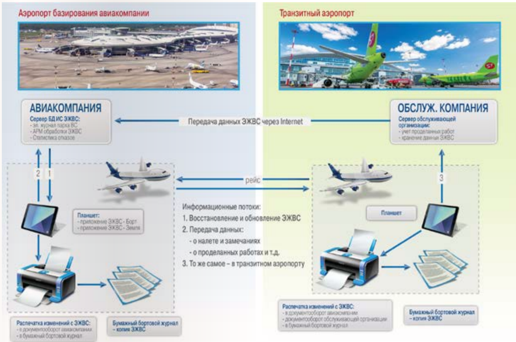
Рис. 4. Структурная схема организации передачи данных в транзитных аэропортах
