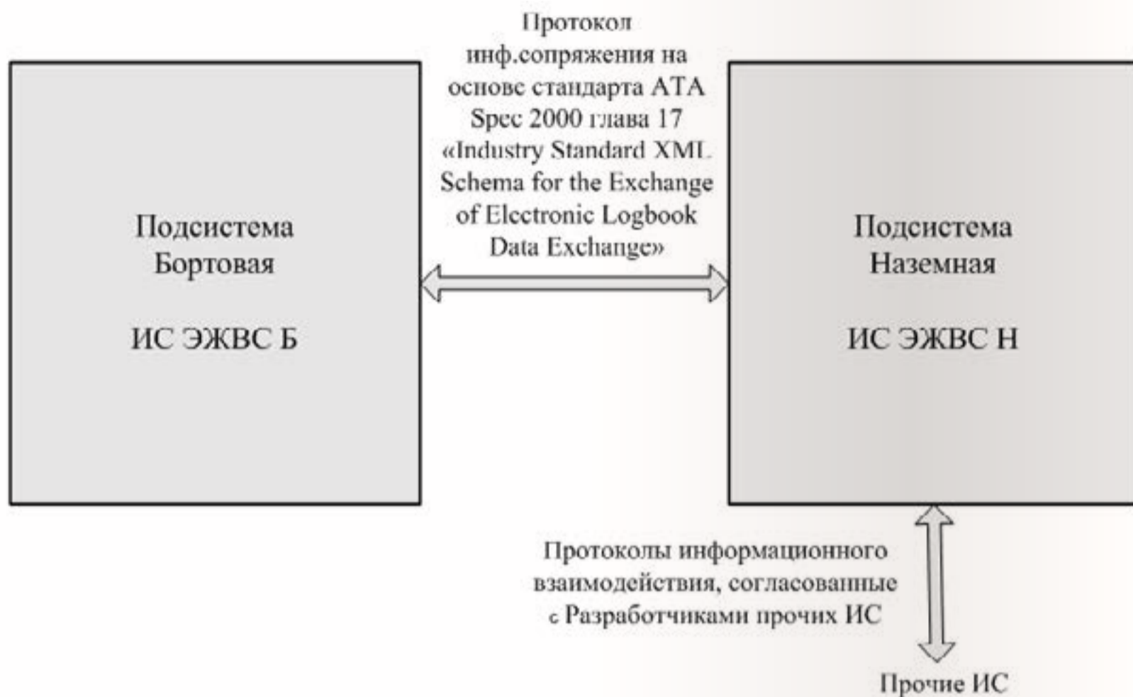
Рис.3. Структурная схема ИС ЭЖВС
