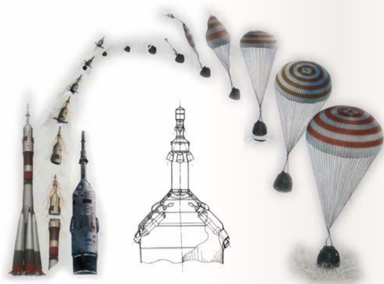
Рис.3. Технологический порядок срабатывания САС и парашютной посадочной системы, которая функционирует на РН-КК «Союз» (вариант)
