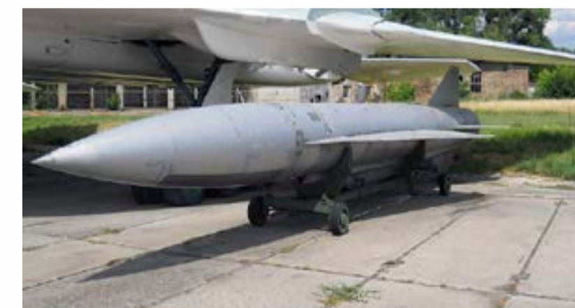
8.2. Противокорабельная сверхзвуковая КР Х-22НА [39]
