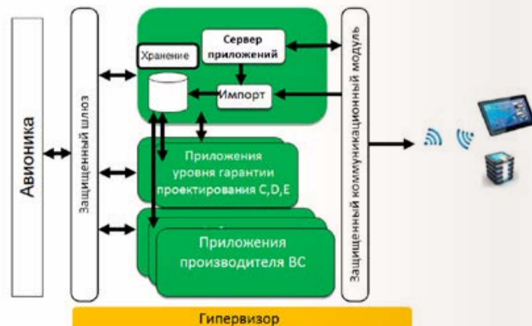
Рис. 13. Создание независимых уровней безопасности с помощью гипервизора
