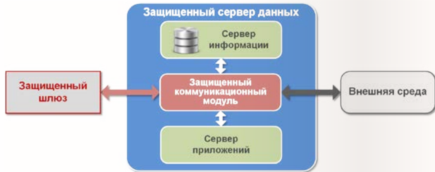
Рис. 8. Состав и принцип работы бортового защищенного сервера
