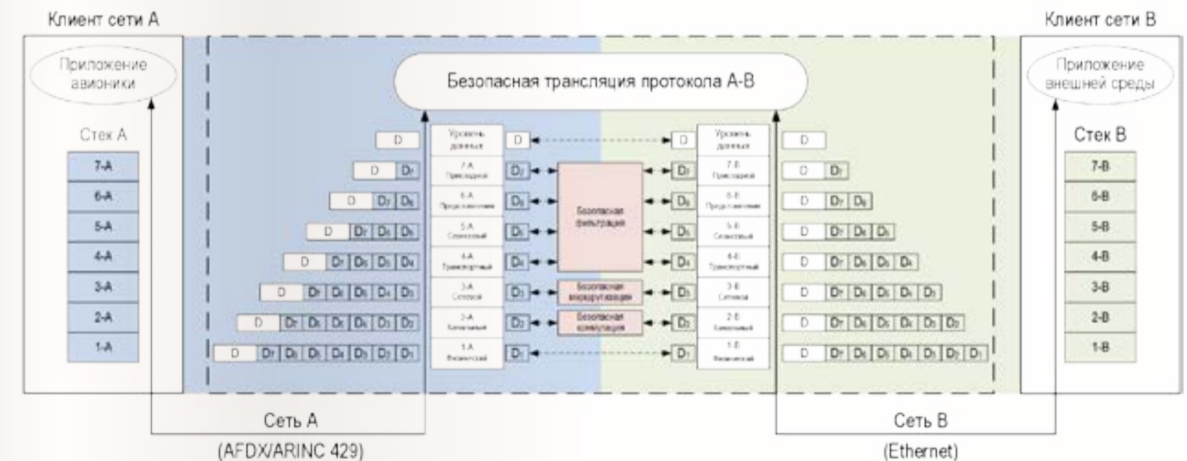
Рис. 7. Принцип работы бортового защищенного шлюза
