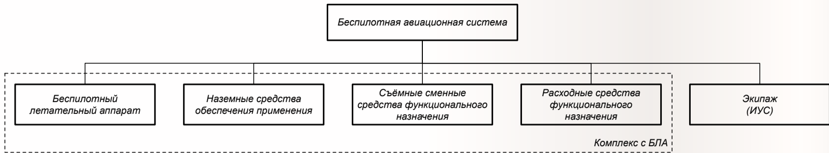
Рис. 1.1. Структура беспилотной авиационной системы
