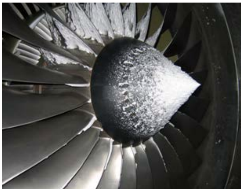
Испытание двигателя на обледенение
