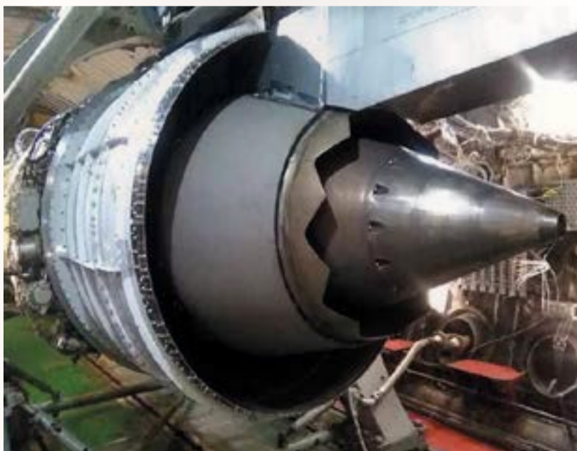
Двигатель ПД-14 на испытательном стенде
