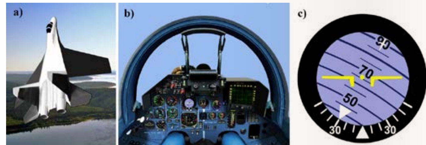
Рис. 12. Пример сложного пространственного положения самолета и соответствующая инструментальная информация по углам крена и тангажа.
