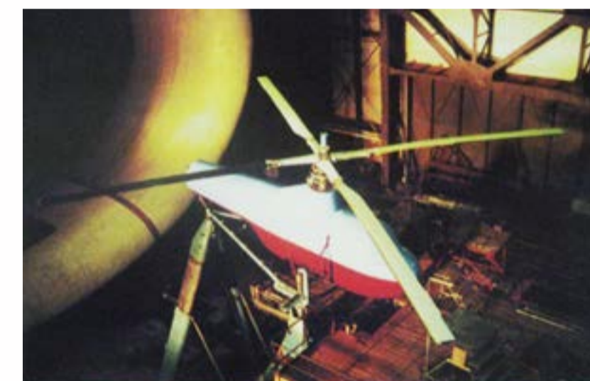
Технология измерения деформации попастей натурального винта вертолета на основе лазерной видеограмметрии.
