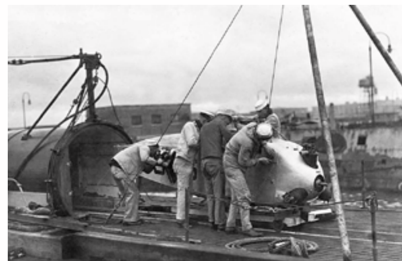
Рис.21. Сборка биплана Caspar U1 на палубе субмарины S-1, США, 1923 г.
