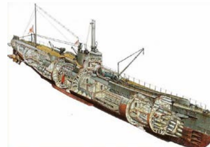
Рис.27. Схематический разрез субмарины-авианосца I-400, Япония, 1943 г.
