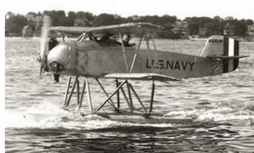
Рис.22. Цельнометаллический биплан Cox-Klemin XS-1, США, 1926 г.
