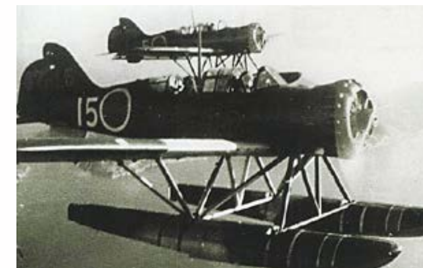
Рис.24. Поплавковый моноплан E14Y для океанских субмарин, Япония, 1929 г.
