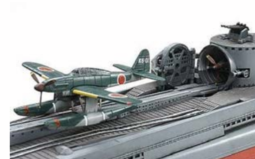
Рис.31. Палубный бомбардировщик M6A1 Seiran на катапульте субмарины I-400, макет.
