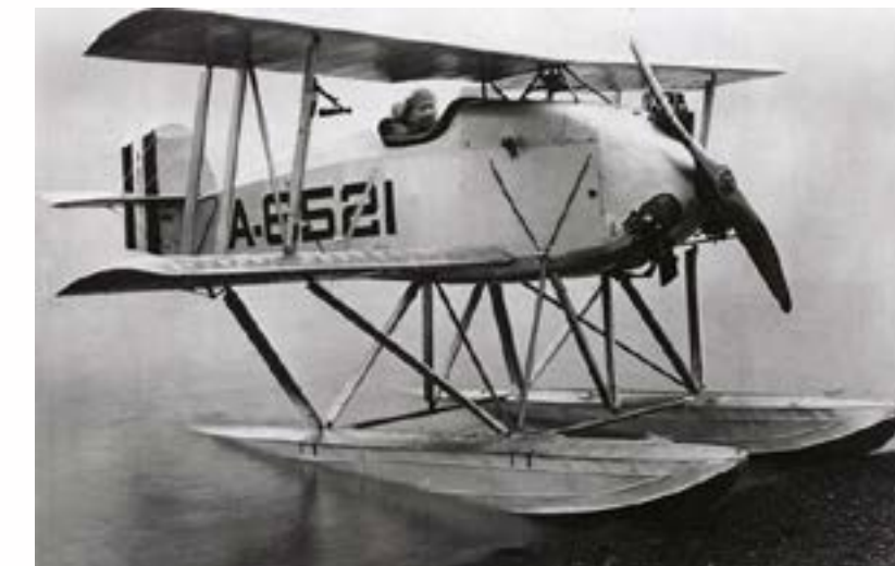
Рис.18. Гидросамолёт-биплан Caspar U1 для подводного базирования, Германия/США.
