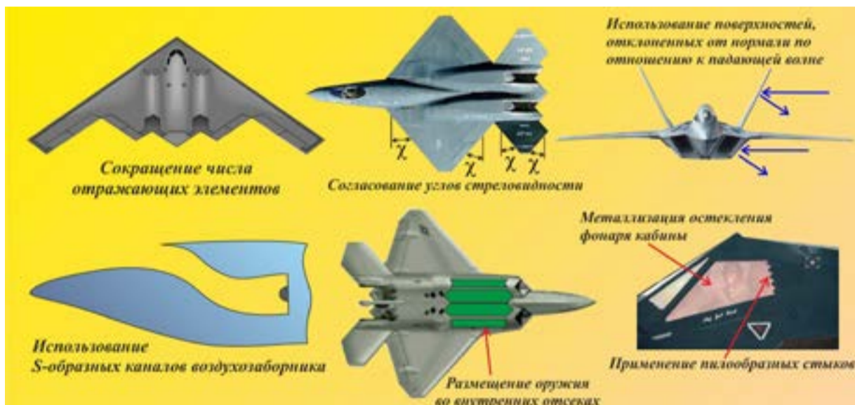
Рис. 4. Основные правила компоновки малозаметного самолета
