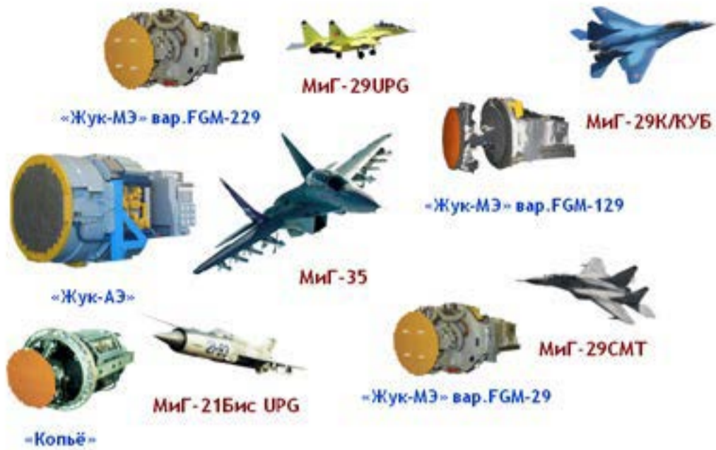
Рис. 9. Модернизация БРЛС на самолётах семейства «МиГ» на базе БРЛС «Жук-АЭ»
